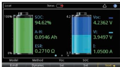
生成したバッテリー・モデルから残容量、劣化等のさまざまな状態をシミュレートしてデバイスのテストが可能です。
