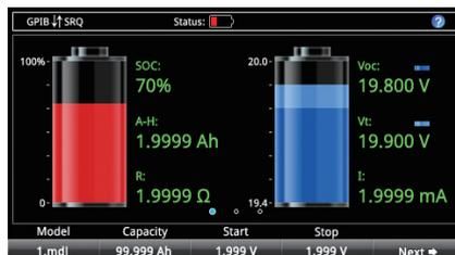
Vocが一定のスタティック・モードとVocが放電に伴って変化するダイナミックモードの二つのモードが切り替え可能です。
