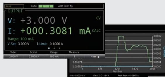
DMM品質の測定と電圧・電流値のグラフ表示が可能
