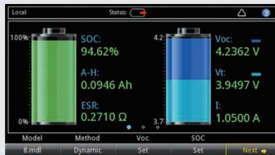
バッテリー・モデルからデバイスに給電し、さまざまなバッテリー状態でのテストが可能
