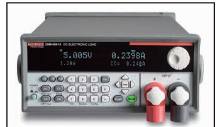
2380-500-15型の前面パネル。入力端子に安全カバーが付いている
