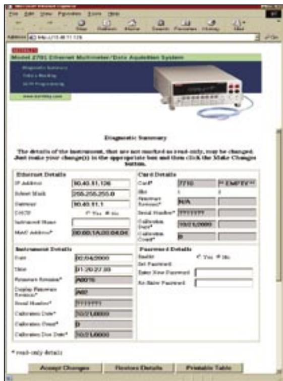
最初に 2701 型と通信をする時は、Microsoft Internet Explorer を起動させて、IP アドレスを URL のラインにタイプします。他のソフトウェアをインストールする必要もなく、内蔵されているウェブ診断ツールが通信、デバッグを容易にしてくれます。
