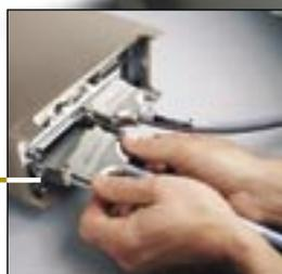
堅牢な50ピンD-subコネクタにより、テストラック内での脱着が簡単
