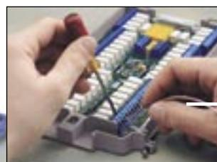
簡単でミスのない接続のために、入力端子に大口径ネジを使用
