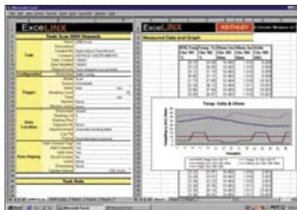
込み入ったデータロギング作業の場合、この効果的で経済的な Microsoft Excel へのアドインを使用することによって、2701 型が収集したデータを Excel に直接転送し、Excel のグラフ、チャートそして解析機能を用いて使いやすい情報に変換することができます。プログラミングは不要であり、マウスのクリックのみで、チャンネル構成や、パラメータ設定、トリガ設定、そしてスキャンリストが作成できます。ExcelLIX-1A は最大 3 台の 2701 型の制御が可能です。
