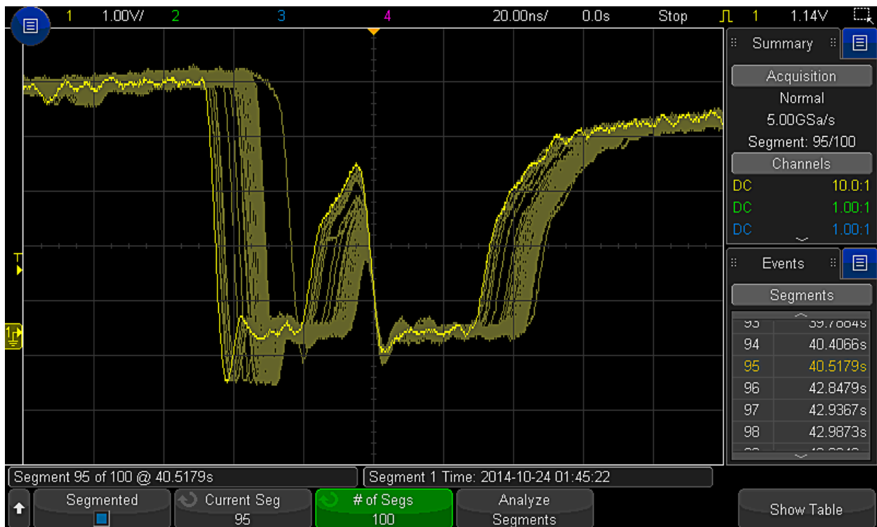
図14. ワーストケースの波形解析のために100個のセグメントをすべて重ね書きした画面表示。
