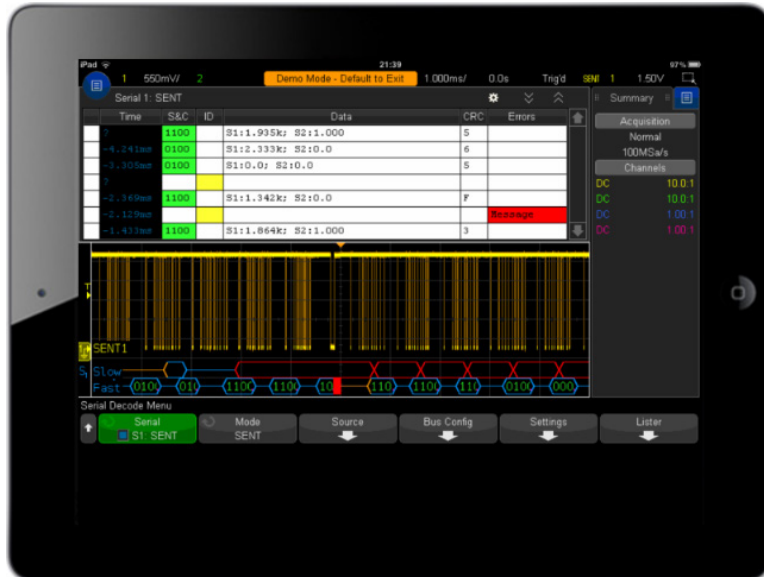
図7. タブレットデバイスによるInfiniiVision 3000G X-シリーズ オシロスコープのリモート制御。
