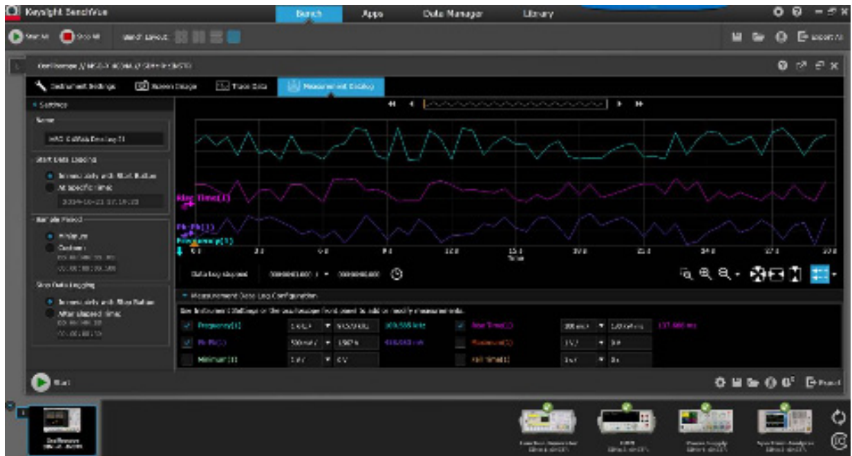
図5. BenchVueを使用した測定データのリモートロギング/プロット。
