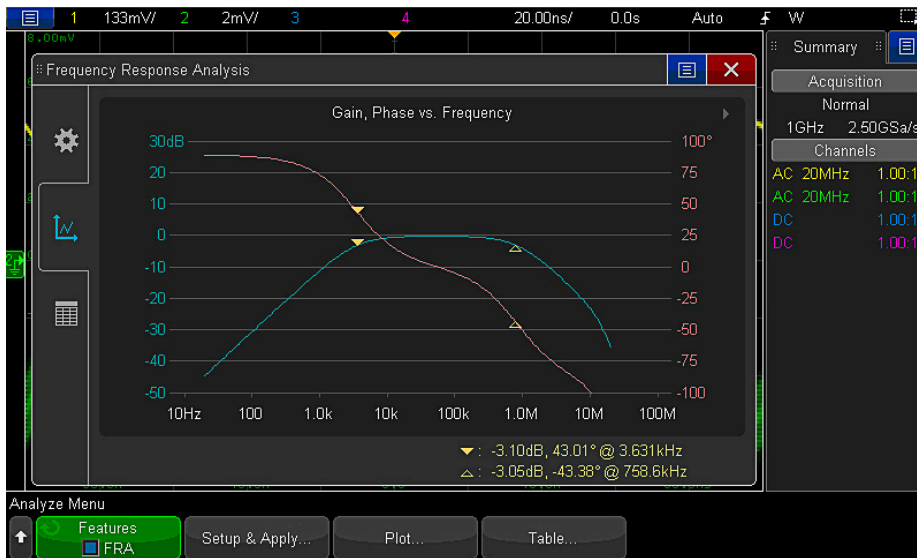
図28. バンドパスフィルタの周波数応答解析プロット（利得と位相のボード線図）。
