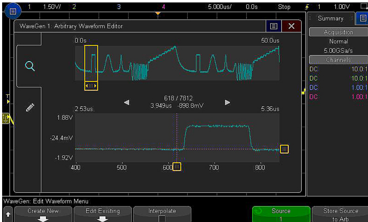
図29. 標準の任意波形発生器で、信号出力への簡単なアクセスを提供します。内蔵の任意波形発生器を使用すれば、捕捉した信号を簡単に編集／再生できます。
