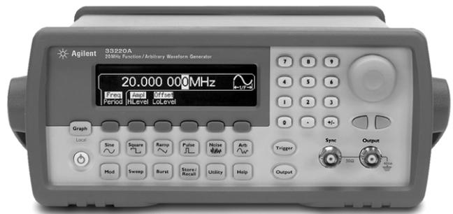
使用して、周波数、振幅、オフセットおよびその他のパラメータを調整します。電圧値もV<sub>p-p</sub>、V<sub>rms</sub>、dBm、またはハイ・レベルおよびロー・レベルとして直接入力することができます。タイミング・パラメータについてはヘルツ(Hz)または秒で入力します。
