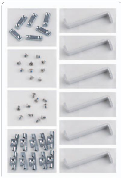
34194A デュアルロック・リンク・キット： 複数の測定器を並べて連結する場合に使用 します。奥行き異なる測定器を連結する 金具が付属します。34191A 2Uデュアル・ フランジ・キットと組み合わせれば、 高さ2U、1/2幅の測定器を2台横に並べて マウントできます。
