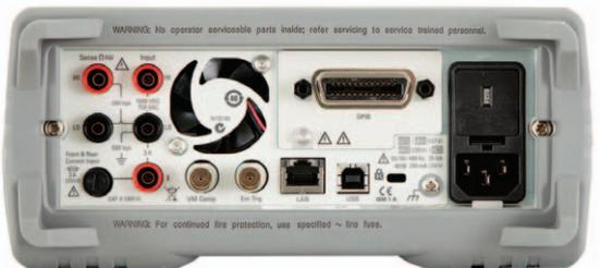
34461A DMMリア・パネル(GPIBオプション搭載)
