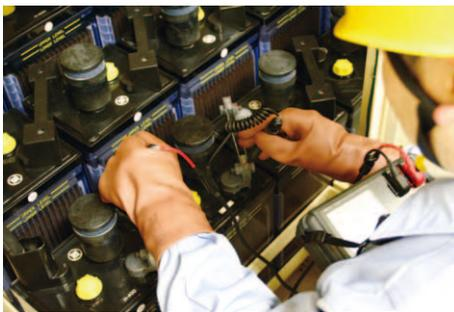
二次電池は充放電の繰り返しにより劣化が進むと、内部抵抗が増加します。また、内部セル短絡などによる故障では電圧の低下や、バッテリー自体の発熱が原因で出火に至るケースもあります。バッテリーハイテスタ 3554は、主にUPSのバックアップ用バッテリーなど、鉛蓄電池の内部抵抗と電圧について、装置を停止する事なく現場で測定し、劣化状況を短時間に診断できるテスタです。
