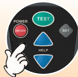
\* NVP 値とは、光速に対する信号の伝搬速度の割合です。NVP 値はケーブルの種類やペアのツイスト状態によって異なるため、測定するケーブルの種類ごとに設定することで測定精度を上げることができます。
