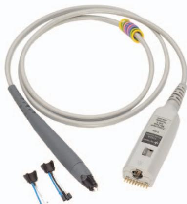
N2750Aシリーズ InfiniiMode差動プローブは、InfiniiVision 3000 X/4000 X/6000 XシリーズおよびInfiniiumオシロスコープのAutoProbeインタフェースに対応する、低価格の新世代差動アクティブプローブです。
