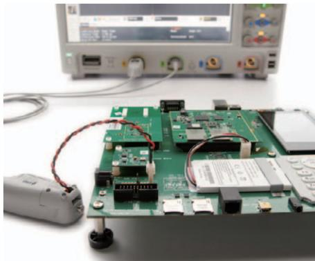
最新のバッテリー駆動デバイスや集積回路のエネルギー効率の向上に伴い、デバイスの消費電流が許容範囲内であるかどうかを確認するために、高感度で低レベルの電流の測定の必要性が高まっています。N2820A高感度プローブは、今日の要求の厳しい電流測定ニーズに対応するために、広いダイナミックレンジで高感度測定が行えます。超高感度のN2820A AC/DC電流プローブを使用すれば、キーサイトのオシロスコープで50  $\mu$ A ~ 5 Aの電流測定を行うことができます。N2820A インタフェースは、別の接点が開く前に閉じるメイク・ビフォア・ブレイク (MBB) コネクタを採用しているため、リード線のはんだ付けや、はんだ付けされたリード線の取り外しを行わなくても、DUT上のさまざまな位置にすばやく接続できます。N2820A 2チャンネル電流プローブは、オシロスコープの2つのチャンネルに接続して、低利得ビューと高利得ビューを同時に表示して、ダイナミックレンジの広い測定が行えます。一方、N2821A 1チャンネル電流プローブでは、一度に1つの表示を選択できます。
