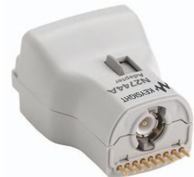
N2744A T2Aインタフェースアダプターを使用すれば、特定のTektronix TekProbeインタフェースレベル2プローブを、キーサイトのAutoProbeインタフェース搭載のオシロスコープで使用できます。既存のTekProbe-BNCプローブをT2Aアダプターに接続し、T2AアダプターをInfiniiVisionまたはInfiniiumオシロスコープのAutoProbe入力チャンネルに直接接続するだけで使用できます。オシロスコープのメニューでプローブモデルを選択すれば、Keysightオシロスコープが減衰比とプローブタイプを自動的に設定します。必要なプローブ電源はT2Aインタフェースアダプターから供給されます。接続されたTekProbeプローブの校正(特定のモデルのみ)とオフセット制御も提供されます。このアダプターにより、TekProbe-BNCレベル2インタフェース搭載のTekアクティブプローブと、AutoProbeインタフェース搭載のKeysightオシロスコープを組み合わせて使用できます。
