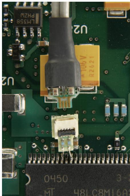
基板の上のはんだ付けされたInfiniiMax ZIFチップ
