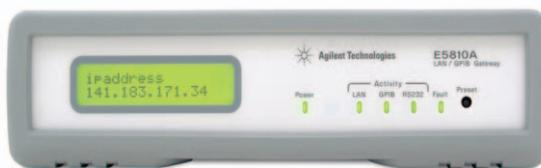
GPIB測定器/テスト・システムにLANテクノロジーを活用できます
