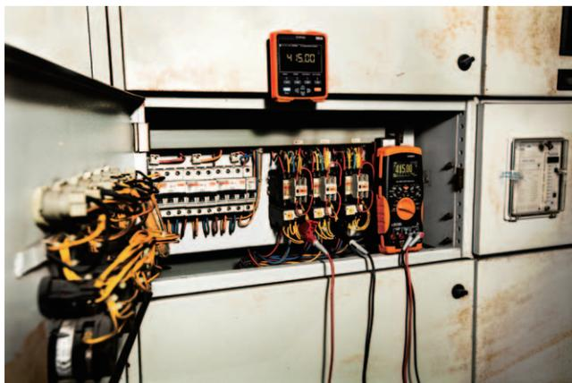
図3. U1115Aリモート・ロギング・ディスプレイでハンドヘルドメータの測定をモニタ
