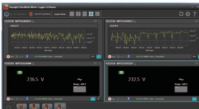
図14. Keysight Handheld Meter Loggerソフトウェアは、最大10台のハンドヘルドメータの測定値やトレンドグラフを表示可能
