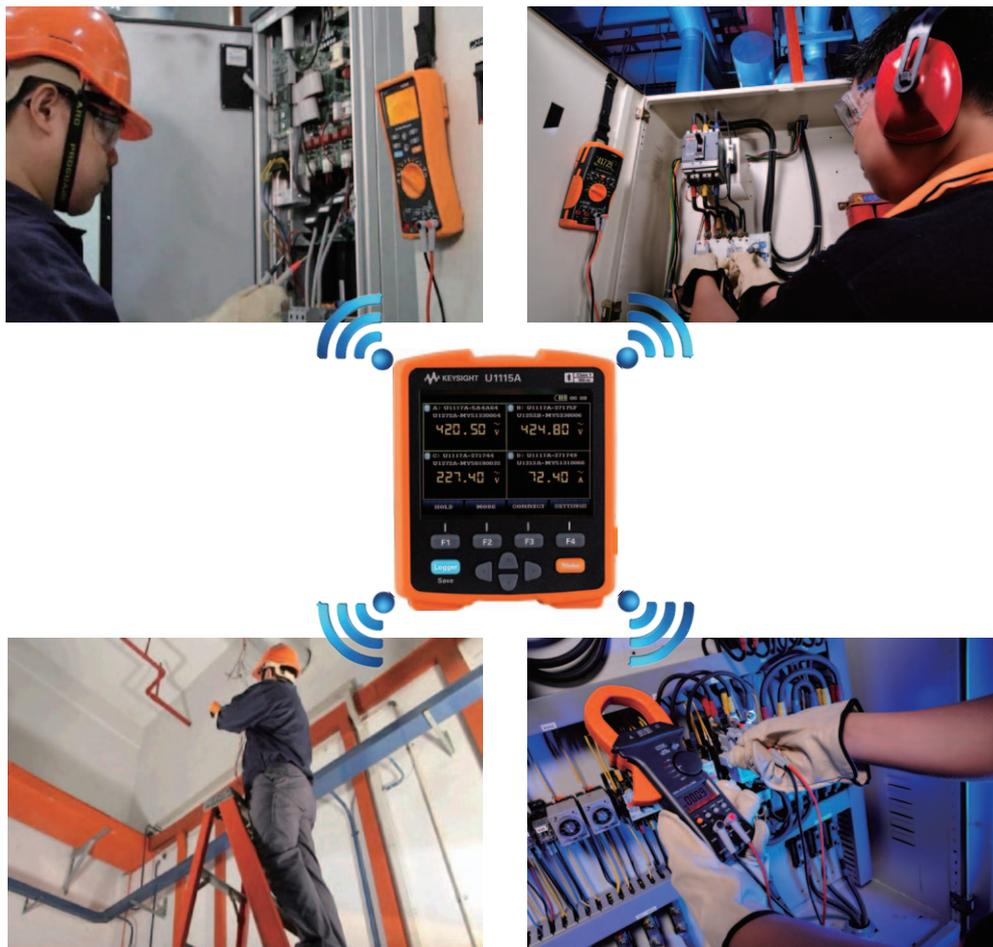
図9. U1115Aリモート・ロギング・ディスプレイでは、最大4台のハンドヘルドメータをモニタ可能
