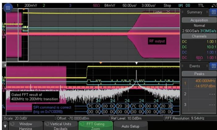
図21a：SPIコマンドでトリガされたRF信号は、リスタに示されているように、400 MHzのままです。
