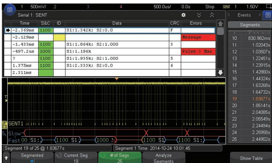
図20 : シリアルデコードと連動したセグメントメモリにより、シリアルバスの動作を容易に解析できます。
