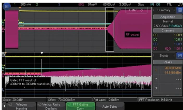
図21c：200 MHzのRF信号のモニタを開始します。RFアナログ波形からも検証できます。
