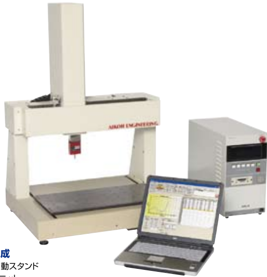
タクトスイッチ フィーリング試験
