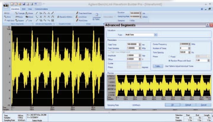
図3. マルチトーン信号：マルチトーン・セグメント・ツールを使用してマルチトーン信号(最大64トーン)を作成することにより、通信機器を解析することができます。
