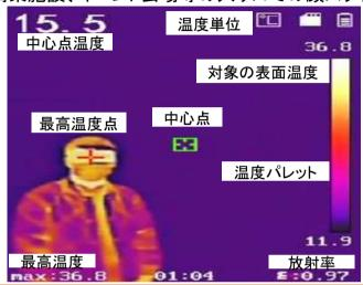
30°C~45°Cの狭いレンジで 温度検知精度±0.5°Cを実現 高い体表面温度をリアルタイムで素早く検知 レーザーポインターがなく、安
