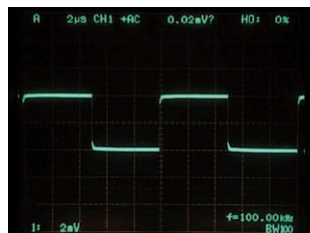
入力：100 kHz 矩形波 400 mAp-p (オシロスコープの帯域 100 MHz)
