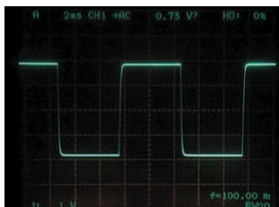
入力：100 Hz 矩形波 300 Ap-p (オシロスコープの帯域 20 MHz)
