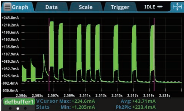
調整可能なカーソルと統計値による波形の表示と解析
