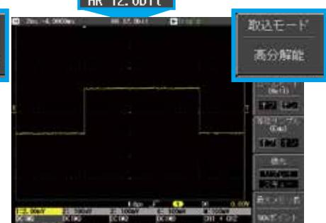
High Resolution(高分解能)12ビット分解能相当時
