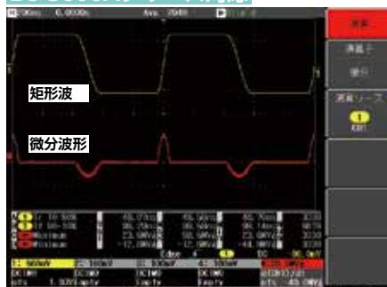
矩形波(立ち上り: 50ns、立下り: 100ns)に対する微分演算波形(矩形波のエッジの時間変化の大きさ( $\frac{dv}{dt}$ )を表示しています。)
