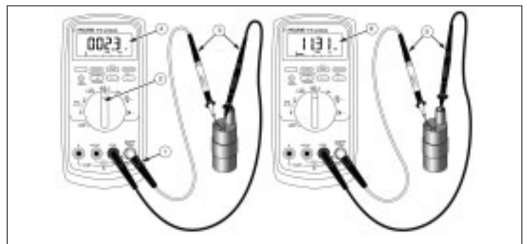
イグニッション・コイル内部抵抗の測定
