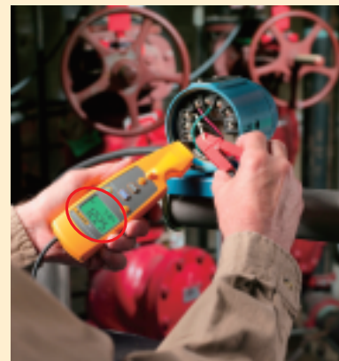
ループの切断無く4-20mA信号をクランプで測定
