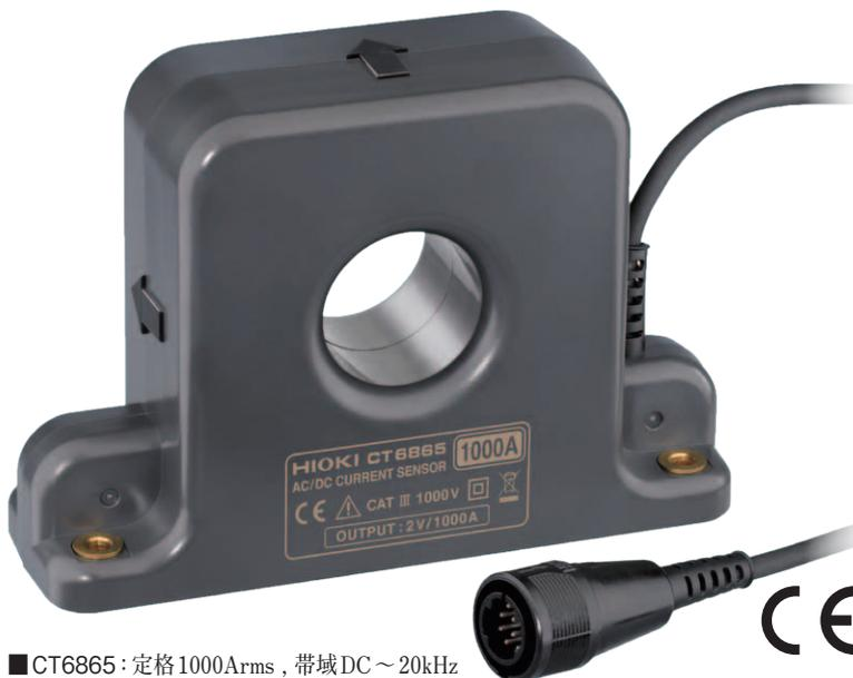
AC/DCカレントセンサ CT6865は、広帯域・高精度の電流センサです。急速に進む省エネ・エコ技術の普及。大規模太陽光発電やEV,HEVなど、電気を活用した省エネ技術はさらに大規模化が進んでいます。CT6865はDC～20kHzの広帯域を持ち、太陽光発電のDCからインバータの2次側測定まで幅広くフォローします。直結式の電流計と同等の精度で大電流測定にご活用いただけます。
