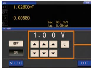
発生電圧を DC 0 V ~ 2.50 V (10 mV 分解能) まで発生可能。
