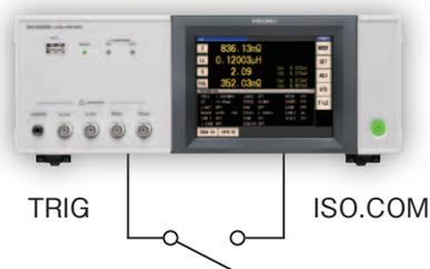
トリガ設定を [外部トリガ] に選択、EXT.I/O 端子の TRIG で測定 & 保存をフットスイッチなどで外部制御できます。
