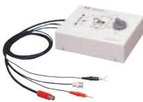
チップコンデンサの絶縁抵抗測定用電極。治具は **0 mm から 11 mm まで任意調整** でき各種チップコンデンサの測定が可能。インターロック接続ケーブルで本体と接続すると、蓋が開放状態では測定電圧は「OFF」となります。
