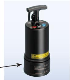
表面抵抗測定用点検治具 SM9002 使用時
