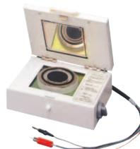
平板試料の固有抵抗測定用電極。試料のサイズは最大 100 mm 角、厚さ 8 mm までの測定が可能。
