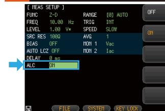
ALC機能は、テスト電圧/電流レベル設定と一致するようにDUTにかかる電圧や流れる電流を自動で調整します。この機能を使用すると、DUTに印加する信号レベルを一定(定電圧または定電流)にすることができます。
