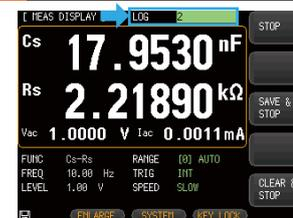
測定値を最大10,000個まで内部データバッファに一時保存し外付USBドライブにCSV形式で最大9999ファイル保存できます。また、外部USBディスクを接続するとEnterキーで画面イメージをBMP形式で外部USBディスクへ最大999ファイル保存できます。
