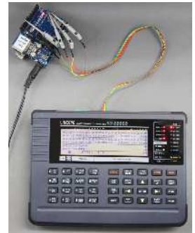
付属の TTL プローブを使用してプリント基板上の SPI 端子をクリップ可能。先端のクリップを取り外し 2.54mm ピッチのピンヘッダコネクタに差し込んだり、高級クリップに交換したりできます。
