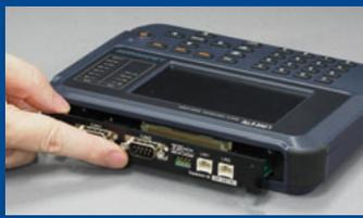
ハードウェア仕様の異なる新たな通信規格にも計測ボードの交換で対応できます。
