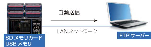
LR8450 本体の SD メモリカードまたは USB メモリに自動保存したファイルを、FTP サーバーに自動で送信できます。
