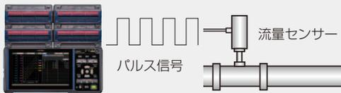
回転数設定では、モーターやドリルなど回転ムラ測定により生産設備の状況モニターに、積算設定では電力量積算や流量積算の測定により、工場管理のデータ取りに活用できます。
