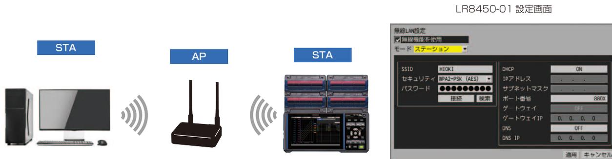
無線 LAN 搭載モデルの LR8450-01 なら市販のアクセスポイント (AP) に接続できます。LR8450-01 をステーション機能 (STA) に設定し接続することで、HTTP サーバーによる遠隔操作や FTP サーバーによるデータの取得ができます。
