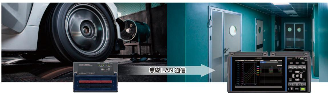
計測対象がある試験室と、データを確認する監視室が扉を隔てた場所の場合、壁に穴を開けて長い配線をする必要がありました。LR8450-01 と無線ユニットなら試験室から多数の長い配線をつなぐ必要がなく、最小限の配線で作業の時間短縮につながります。
