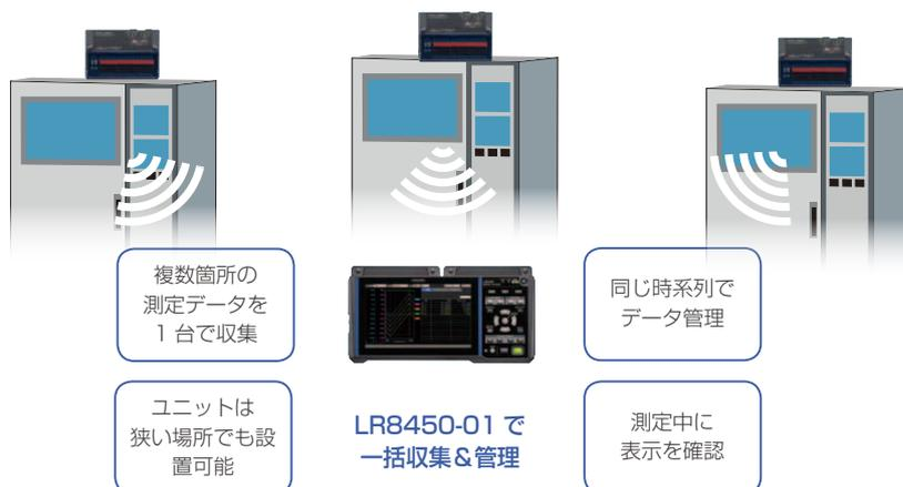
既存のデータロガーを分散した実験設備へ設置した場合、測定結果はデータロガーごとに収集されました。無線ユニットを各実験設備ごとに設置し、LR8450-01 は無線接続すれば、一括で同時に収集できます。
