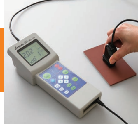
●測定はプローブを試料に対して垂直に
