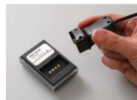
●プローブチェッカーで測定前に点検を
