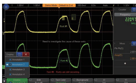
図5：レポート用に一度に最大4つの注釈を画面上に表示できます。タッチパネルを標準搭載しているので、簡単に注釈を入れられます。
