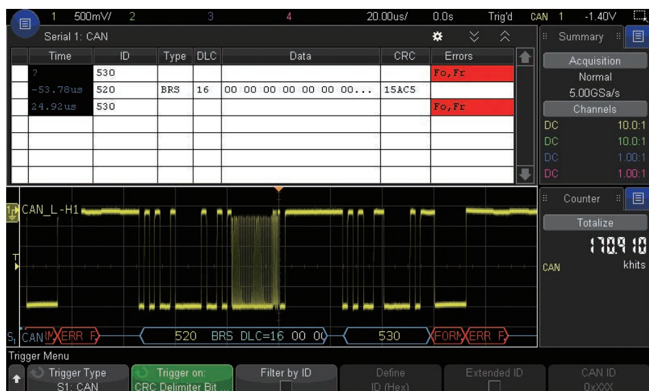
図27：トータライザーはイベント数をカウントします。さらに、1秒間に2500万イベントの速さで、トリガ条件で選別されたイベント数をカウントすることができます。
