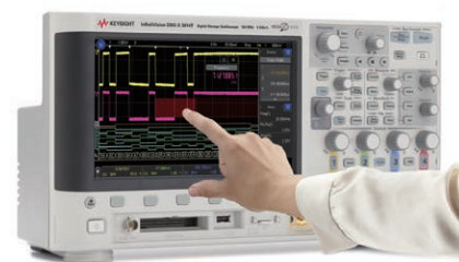
図2：大きなタッチメニューを備えた、業界初の8.5インチ静電容量方式タッチディスプレイ。
