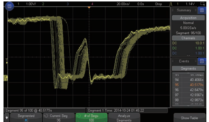
図13a：ワーストケースの波形解析のために100個のセグメントがすべて重ね書きされた画面表示。
