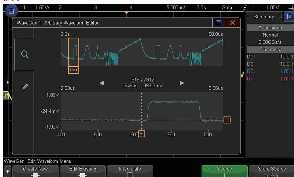
図25：オプションの任意波形発生器を使用すれば、入力信号に簡単にアクセスできます。内蔵の任意波形発生器を使用すれば、信号を簡単に捕捉／変更／再生できます。
