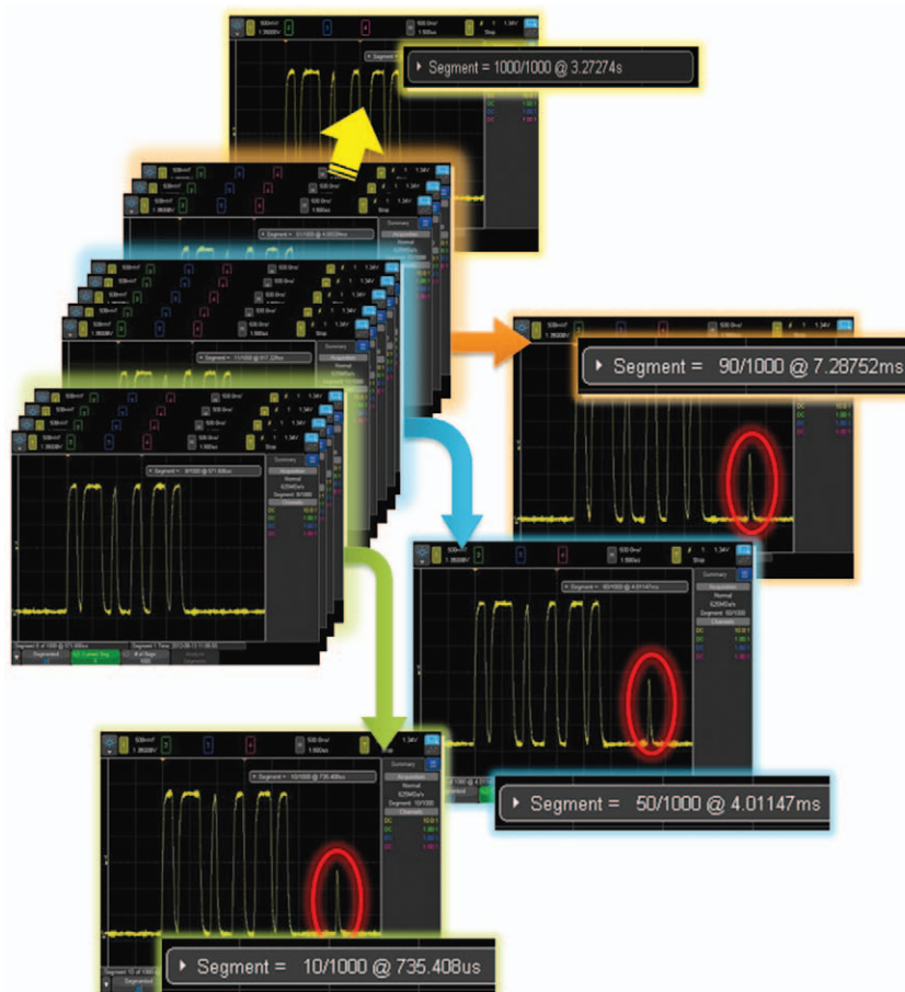
図7： セグメント・メモリは、メモリを効率的に管理し最大1,000セグメントの信号を捕捉することができ、発生頻度の少ないイベントや異常を容易に捕捉できる、事実上の超大容量メモリ・オシロスコープを実現します。
