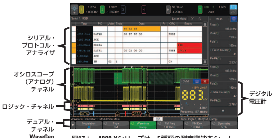
図17: 4000 Xシリーズは、5種類の測定機能をシームレスに1台の測定器に統合しています。
