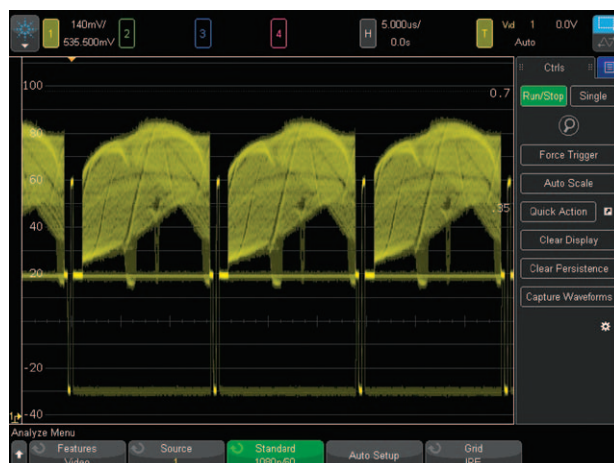
図26: 1080p HDTV信号でのトリガ
