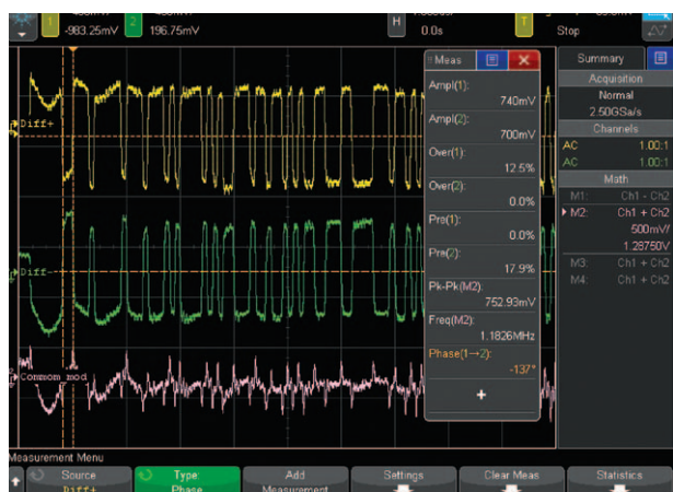
図23： 差動任意信号のデュアル・チャンネルWaveGen出力。共通・モードは演算機能として示されています。
