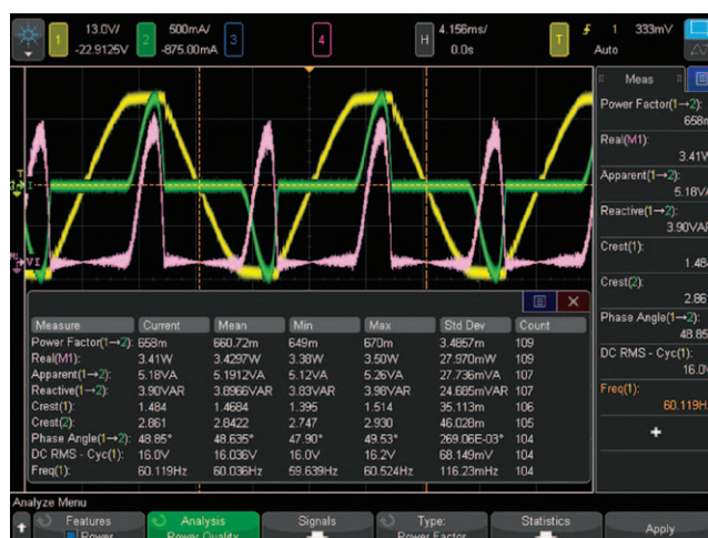
図25: パワー品質測定(多くのパワー測定アプリケーションのうちの1つ)
