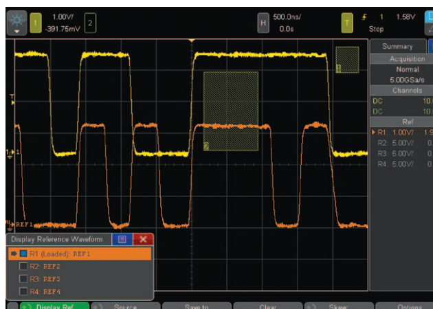
図32： 最大4個の基準波形の保存および呼出し
