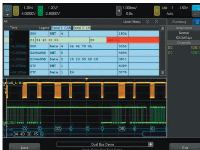
図19： CANとLINによるデュアル・シリアル・バスのデコードとインタリーブされた「リスタ」ディスプレイ
