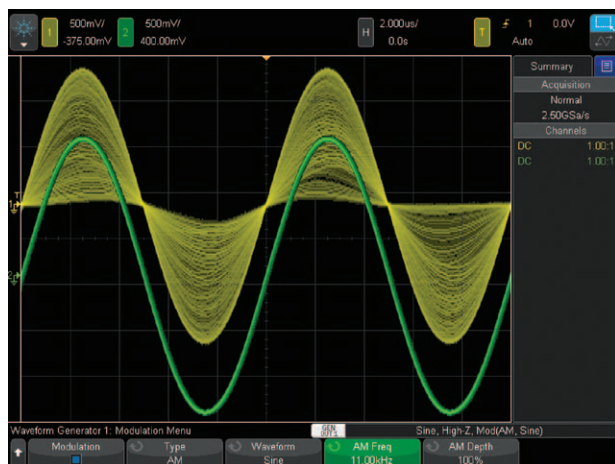
図21： AM変調がある場合とない場合のWaveGenの正弦波出力
