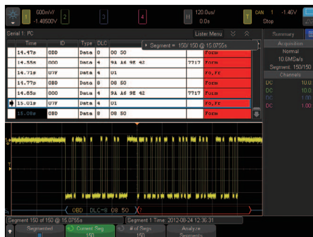
図8： シリアル・デコードと連動したセグメント・メモリにより、シリアル・バスの動作を容易に解析できます。
