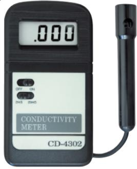
水の濁度の目安となる導電率を簡単測定
