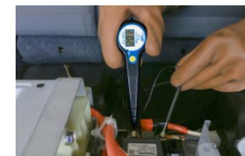
駆動用バッテリーの電圧測定
