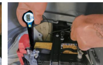
補機バッテリーの電圧測定
