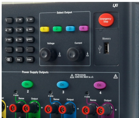
図11. N6705のフロントパネルのUSBポート。
