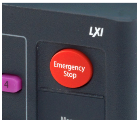
図12. すべての出力を瞬時にシャットダウンする緊急停止ボタン。
