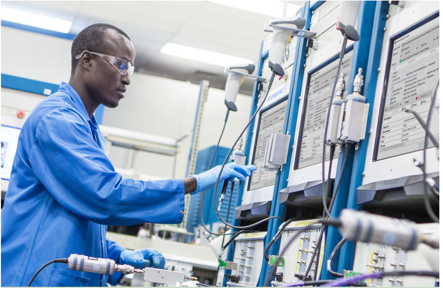
RF製造テストシステムでNI PXIをTestStandとともに使用
