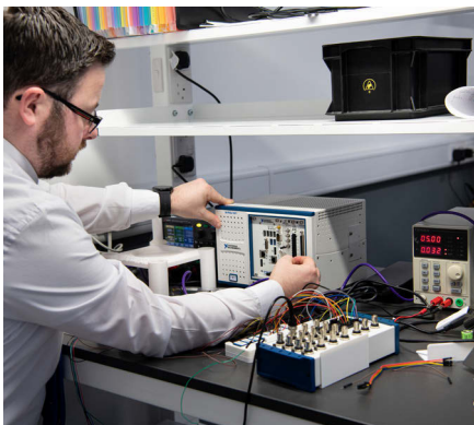
ベンチトップ検証システムで使用されているPXI
