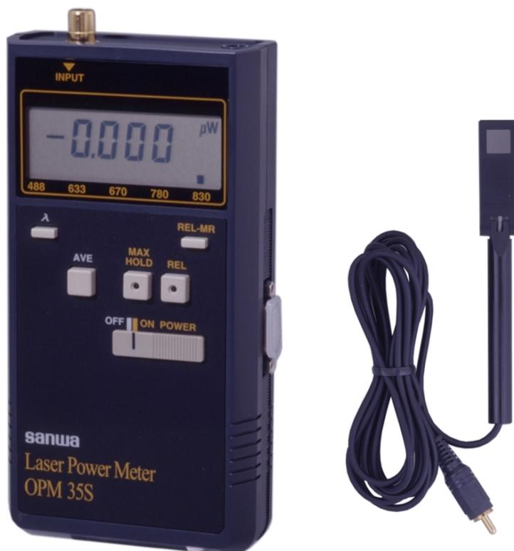
本測定器は受光センサにSiフォトダイオードを使用した空間光測定用のレーザーパワーメータです。光パワー測定範囲は50.00mWまでとハイパワーレーザー光の測定に対応しています。測定機能としてはW測定のほか相対値測定 W (REL) 機能、最大値ホールド機能、平均値処理機能、直読波長切り替え機能(488nm、633nm、670nm、780nm、830nm)を備えております。またRS-232Cインターフェイスを装備しておりますので測定データをパソコンに転送することが可能です。
