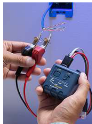
トーン発生器のケーブル接続例
