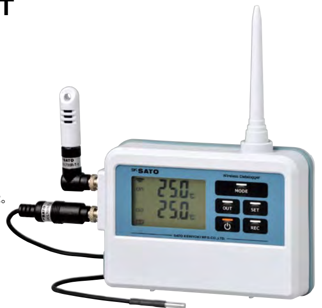
CH1：一体センサ CH2：分離センサ
