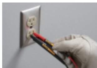
CAT II テストは先端を伸ばして測定
