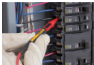
CAT III テストは先端を縮めて測定
