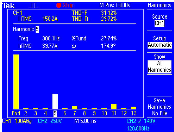
TPS2PWR1 ソフトウェアによる高調波歪みの測定例
