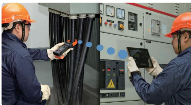
Androidデバイスを使用して、最大10 mの距離から測定結果をモニターし、データを記録することができます。これにより、アクセス困難な環
