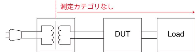
試験用の負荷電源など、電源内部が絶縁されている。電源と DUT が直接接続していない
