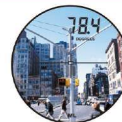
間隔ライン方位角 表示: MLとAZ 指定した2点を結ぶラインが北より78.4°の方向へ向いています。
