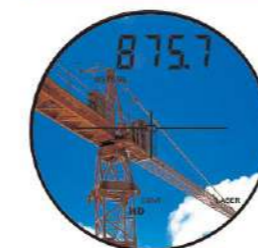
水平距離 表示: HD 目標物までの水平距離が875mであることを示しています。
