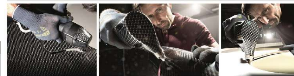
曲線カット スクライプラインの直線カット テンプレートによる継続的な切断
