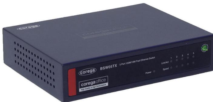
本商品は、SMB/SOHO に最適な 100BASE-TX/10BASE-T に対応した 5 ポートスイッチングハブのメタル筐体 / 電源内蔵モデルです。手軽で高性能な仕様となっており、オフィスでのエントリーモデルとしての利用に特に適しています。
