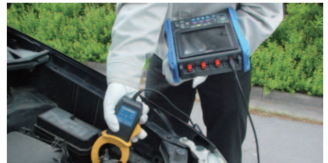
メモリハイコーダ・オシロスコープと組み合わせて モータ・自動車の起動電流、機器のピーク波形測定など
