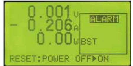
ブースター接続異常
