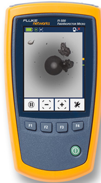
汚れた光ファイバー端面を表示する FI-500
