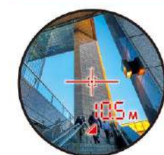
直線（傾斜）距離 トゥルーパルスから 目標物までの直線距離
