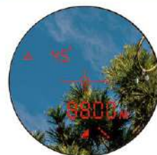
垂直間隔ライン傾斜角：ML+水平距離+傾斜角 指定した垂直ライン上の2点を結ぶラインを斜辺とした直角三角形上の 水平距離が88m、2点間の傾斜角が4.5°になります。
