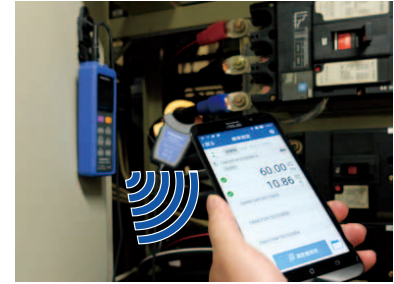
測定結果が無線でタブレットに 送信、表示されます
