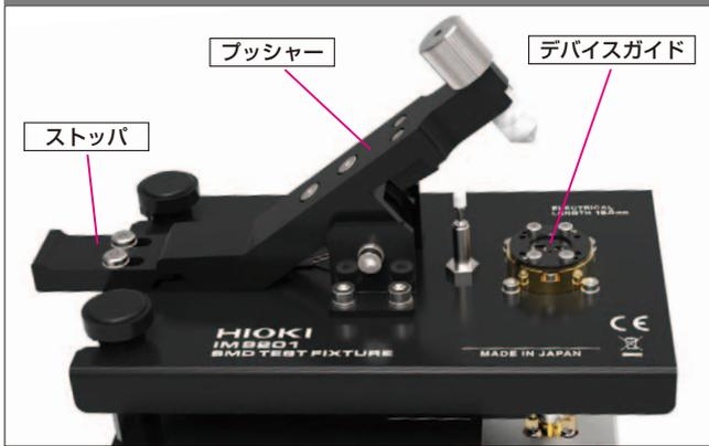
2. ストッパを外し、プッシャーをおろして試料を固定
