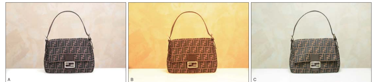
図2. 各光源による色温度の違い A フラッシュ光 (5200K) B タングステン光 (2800K) C 蛍光灯 (5500K)
